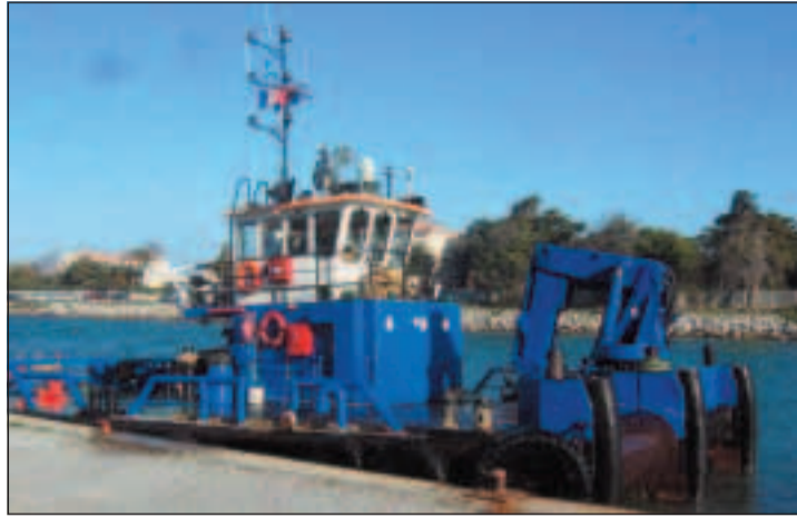
Le Tessa permet de relier les pétroliers au sea-line.
